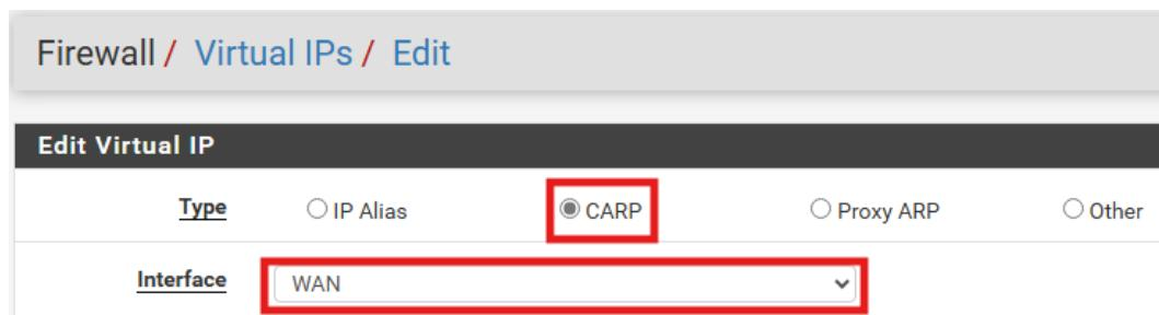
Puis, dans la ligne « Address », nous avons saisi l'IP virtuelle pour l'interface CARP WAN, c'est-à-dire 10.0.85.200/24, car cette adresse doit être dans le même sous-réseau que la passerelle, qui est en 10.0.85.254/24.
